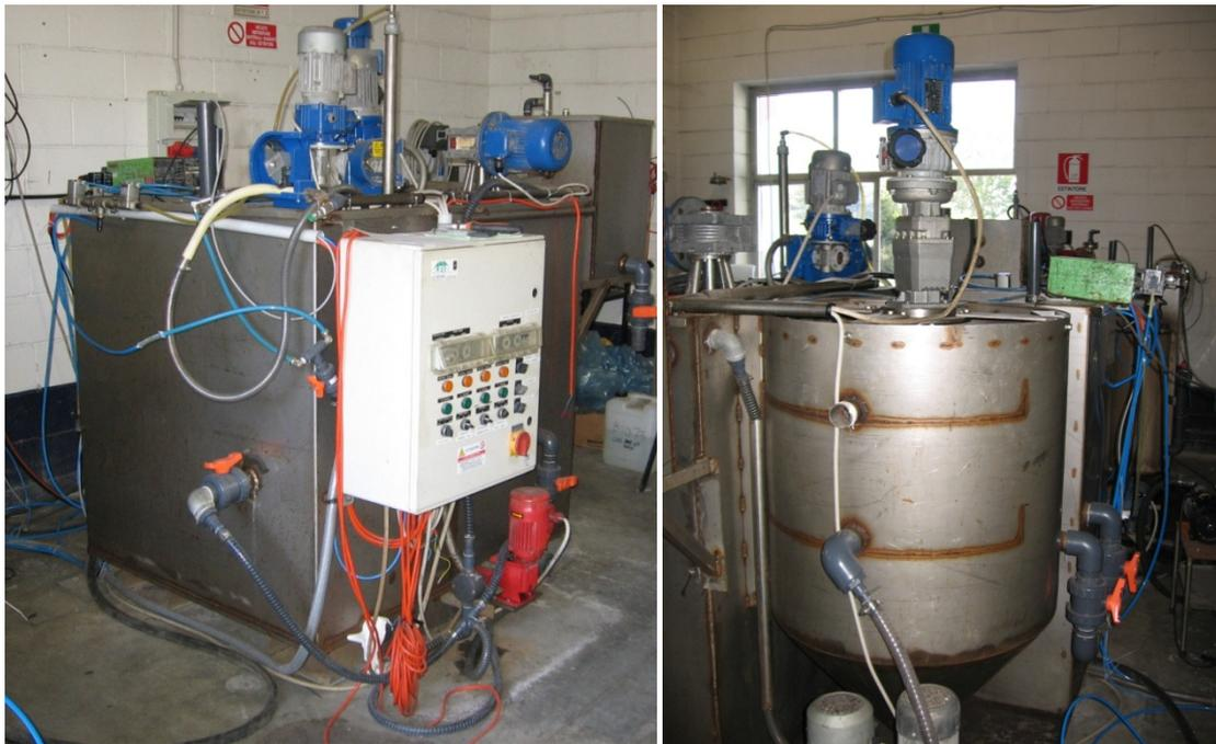
Figura 2-9 Impianto CAS della filiera Main-Stream e particolare del sedimentatore
