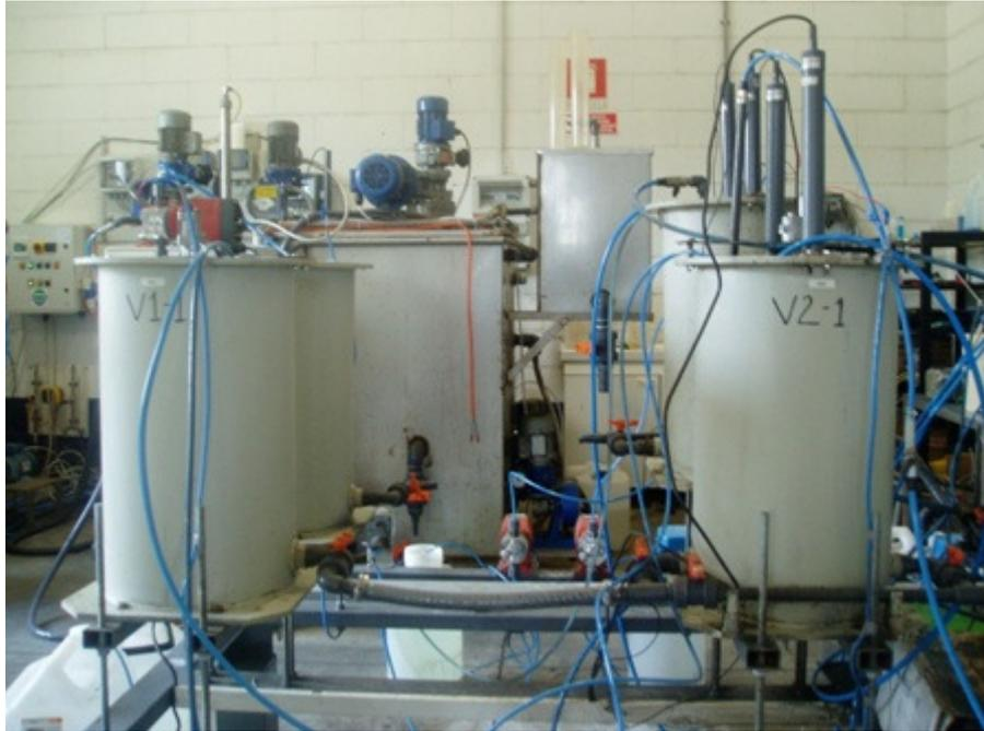
**Figura 2-13** Reattori di denitrificazione (V1-1) e nitrificazione (V2-1) della filiera Side-Stream
