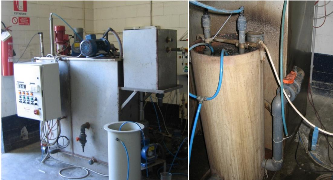
**Figura 2-11** Impianto MBR della filiera Main-Stream e particolare della vasca di filtrazione
