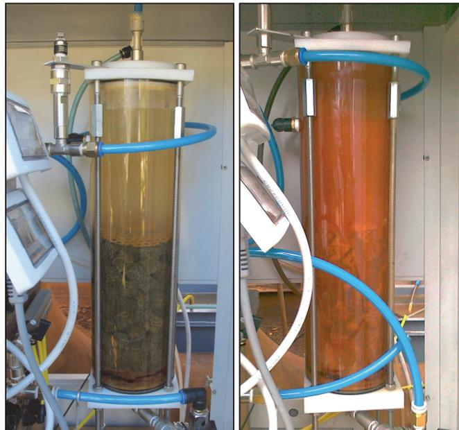
Figura 5.44 - Reattore/ossidatore allo start-up dell'impianto pilota (sinistra) e dopo alcuni mesi di funzionamento (destra).
