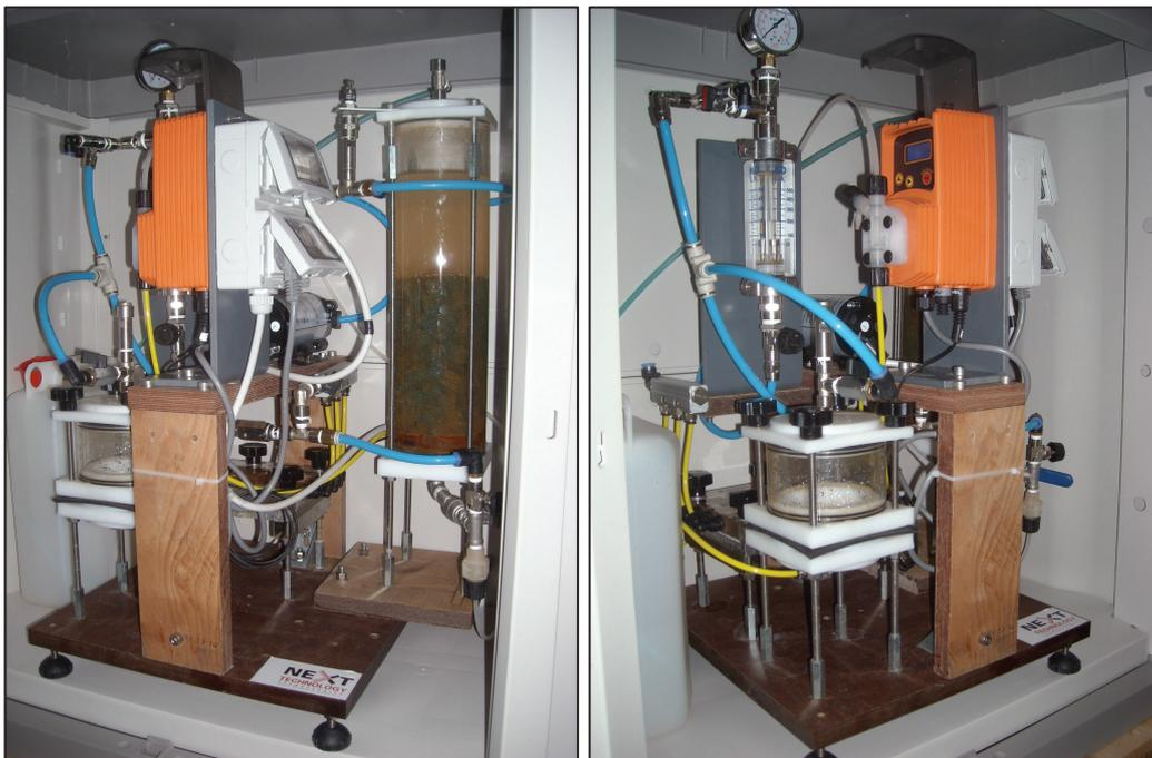
Figura 5.42 - Impianto pilota di ossidazione/precipitazione e filtrazione su TNT.
