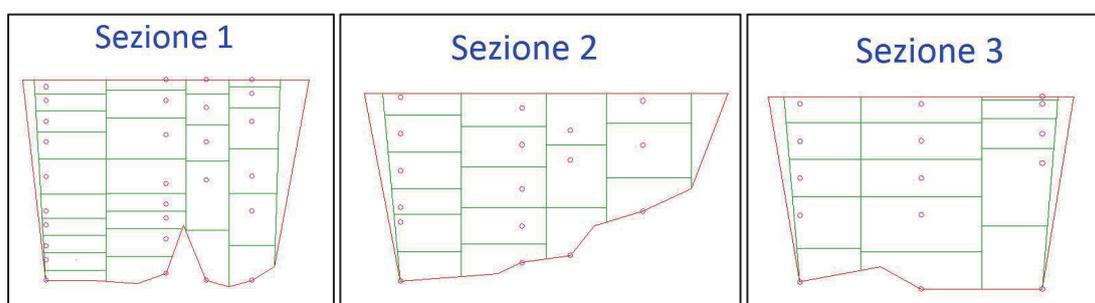
Figura 4.11 - Sezioni di misura della portata lungo il canale di scolo della galleria di Boccheggiano.
