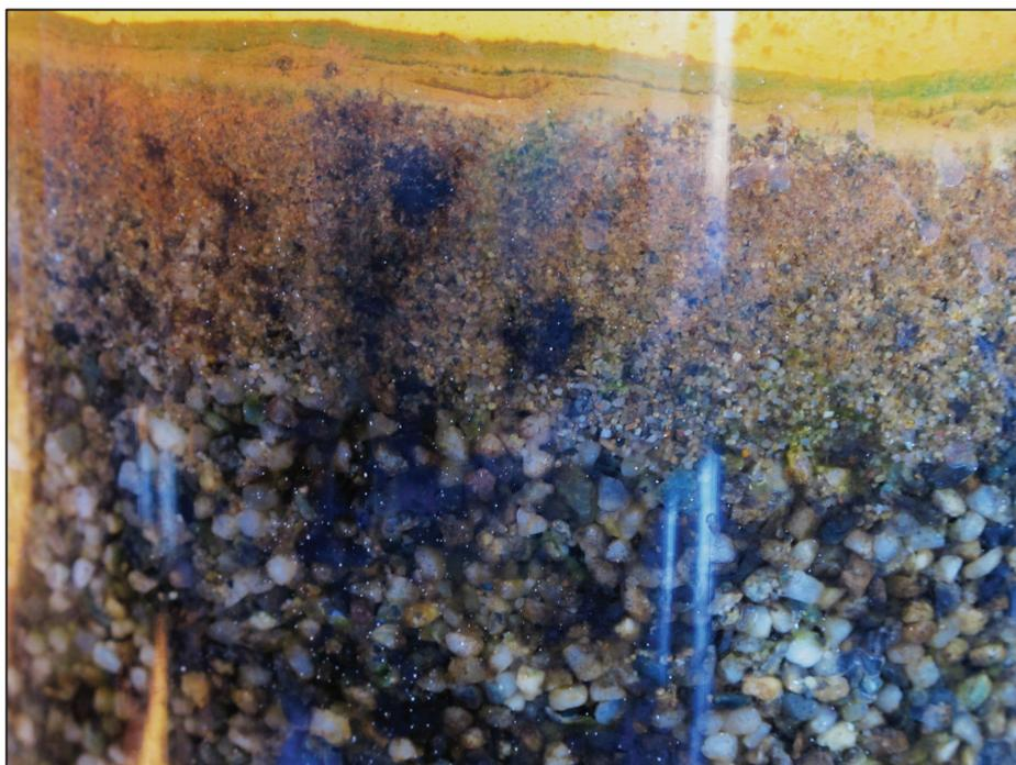
Figura 5.36 - Dettaglio dell'OC accumulato sul filtro a sabbia in situ.
