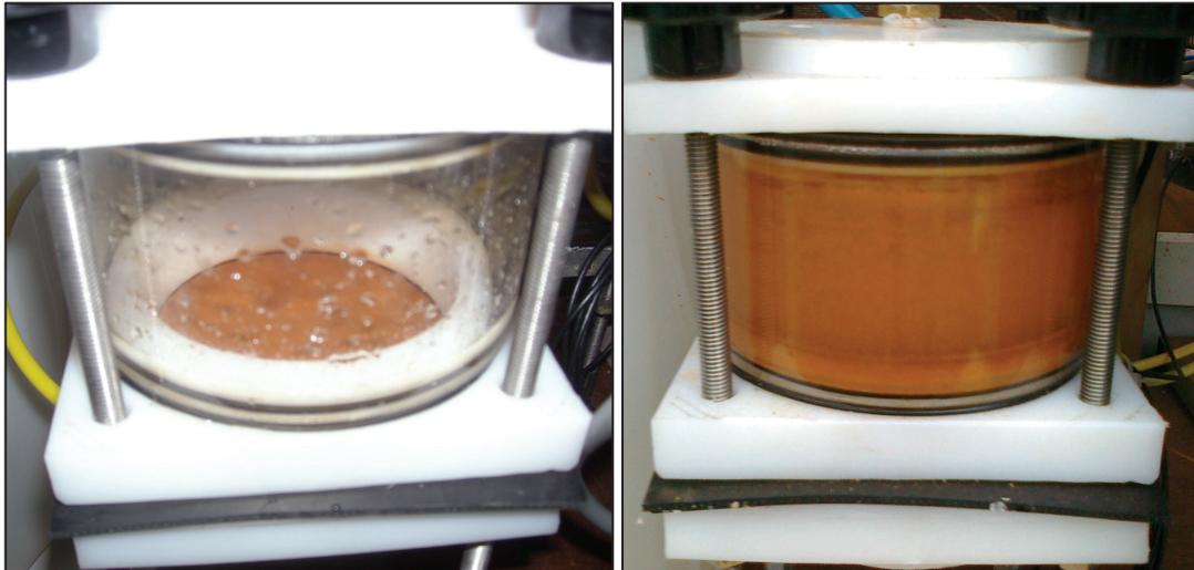
Figura 5.43 – Filtro di TNT allo start-up dell'impianto pilota (sinistra) e dopo alcuni mesi di funzionamento (destra).
