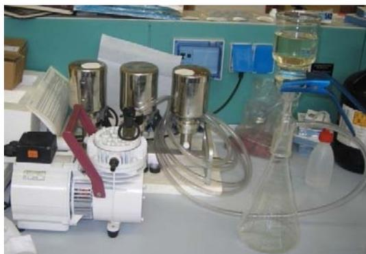
Figura 4.2.1.13: Fase di filtrazione dell'eluato prodotto dal test di cessione.
