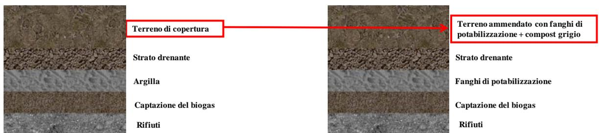
Figura 4.1.4: Tesi sperimentale 2: Sostituzione dello strato minerale compatto con fanghi di potabilizzazione e aggiunta di compost grigio e fanghi di potabilizzazione al terreno di copertura.
