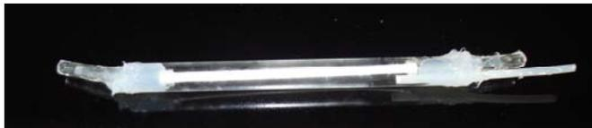
**Figura 5.1 Membrana in polisulfone alloggiata in tubo di vetro**
