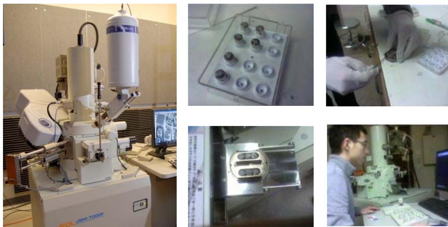
Figura 5.8 Scanning electron microscope (JEOL 7000) - fasi della procedura
